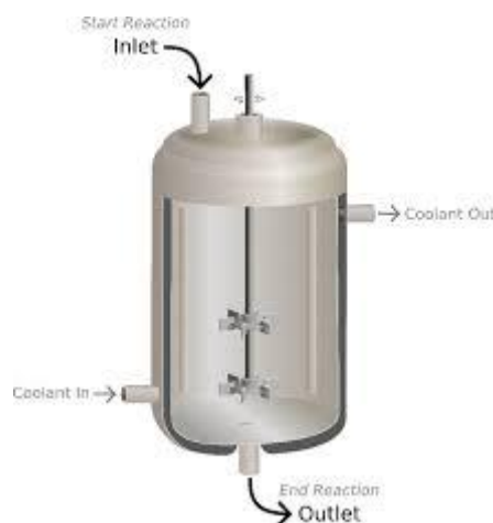
Obrázek 1.4: Schéma výrobního procesu. (Převzato z [1]). Poznámka: 'Start Reaction' = Zahájení reakce, 'Inlet' = Vstup, 'Coolant Out' = Výstup chladicí kapaliny, 'Coolant In' = Vstup chladicí kapaliny, 'End Reaction' = Ukončení reakce, 'Outlet' = Výstup
